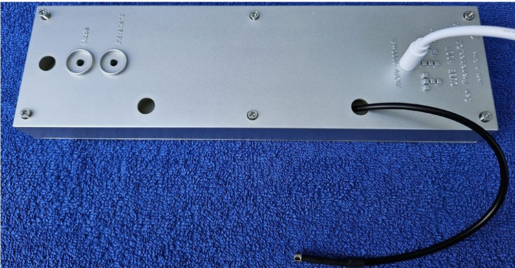
Hinweis: Die beiden Tasten müssen beim Drücken einen eindeutigen Druckpunkt aufweisen (Knacken). Sollte dies nicht der Fall sein, TIX Clock nochmals demontieren und Löcher für die Tasten im Gehäuse mit einer feinen Feile oder einem grösseren Bohrer etwas vergrößern.
