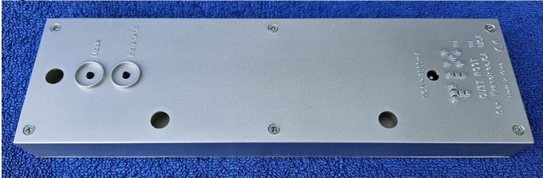
3. Löse und entferne die 6 Schrauben auf der Rückseite.
