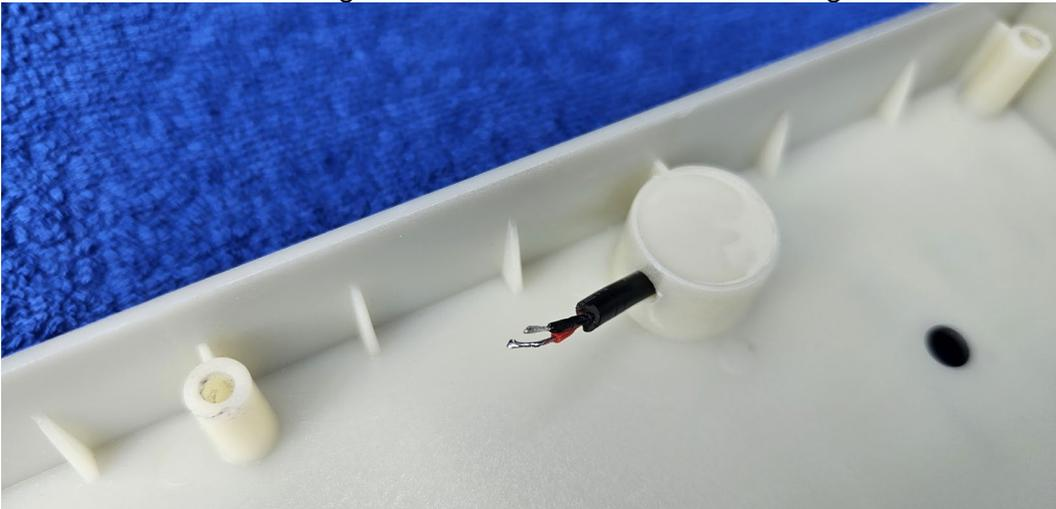
2. Schliesse das Kabel an der Buchse auf der Platine an. Die beiden Adern können beliebig angeschlossen werden (keine Polung).
