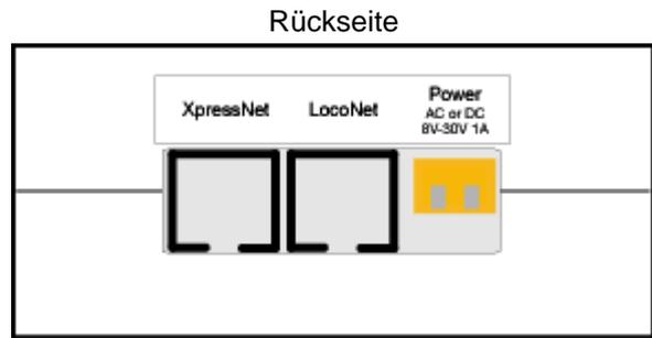
Anschlussseite, jeweils eine Western-Buchse für Loco-Net und XPressNet sowie der Stromanschluss der Basisstation
