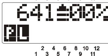
Drücken Sie die Taste „Vorwärts“ erneut, werden 2 Striche unter der Richtungsanzeige sichtbar und die Funktionen F25 bis F28 sind aktiv.
