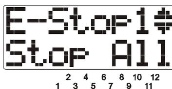
Die Gleisspannung wird abgeschaltet (damit halten natürlich auch alle Lokomotiven sofort an).
