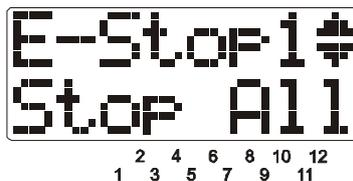
Alle Lokomotiven halten sofort ohne Verzögerung an. Die Gleisspannung bleibt eingeschaltet.
