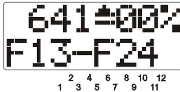
Drücken Sie die Taste „Vorwärts“. Der Strich unter der Richtungsanzeige zeigt an, dass nun die Funktionen F13 bis F24 aktiv sind.
