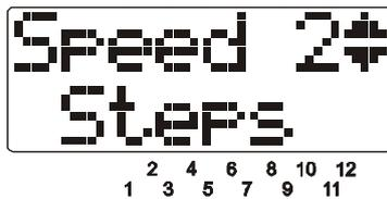
Hiermit stellen Sie die Anzeige der gefahrenen Geschwindigkeit in Fahrstufen ein.
