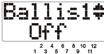
Mit dieser Einstellung ist der Ballistikeffekt ausgeschaltet.
