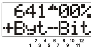
An dieser Stelle müssen Sie auswählen, ob Sie ein komplettes Byte programmieren möchten (also den CV-Wert komplett angeben) oder ein einzelnes Bit einer CV-Variable setzen oder löschen möchten (wird nicht von allen Decodern unterstützt).
