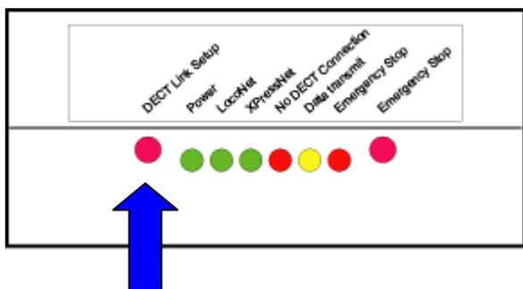
Drücken Sie nun die Taste "DECT Link Setup" und halten Sie diese gedrückt, während Sie die Basisstation wieder an die Spannungsversorgung anschliessen. Halten Sie diese Taste solange gedrückt, bis die gelbe Leuchtdiode "Data transmit" einmal kurz aufblinkt.
