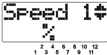
Mit dieser Einstellung erfolgt die Anzeige der gefahrenen Geschwindigkeit in Prozentwerten.
