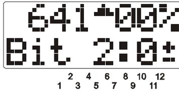
Wählen Sie über die Zifferntasten nun das Bit, das Sie setzen oder löschen möchten (z.B. Bit 2).
