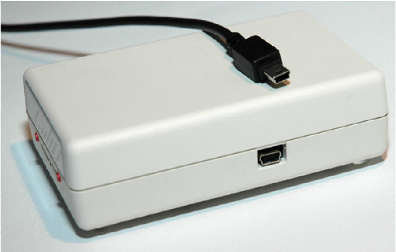
Dieses Bild zeigt eine Basisstation der Seriennummer 3.xxx. Haben Sie eine Basisstation mit der Seriennummer 2.xxx und USB nachgerüstet, so befindet sich der USB-Anschluss auf der gegenüberliegenden Gehäuseseite. Dies hat lediglich mechanische Ursachen (geändertes Platinenlayout), elektrisch und funktional sind die Versionen 3.xxx und 2.xxx mit USB völlig identisch.
