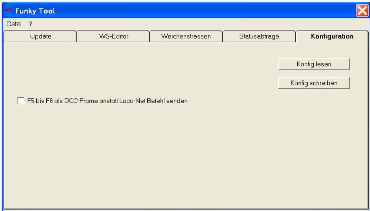
Laden Sie die aktuelle Konfiguration der Basisstation mit einem Klick auf die Schaltfläche „Konfig lesen“.
