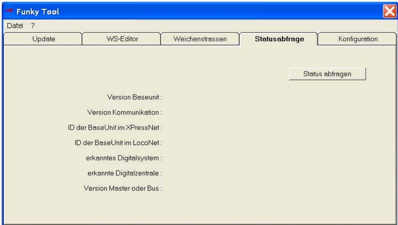
Betätigen Sie nun die Schaltfläche "Status abfragen". Die Software sucht nach der Funky Basisstation (das kann einen Moment dauern) und zeigt Ihnen dann eine Statusübersicht an (in unserem Beispiel eine Basisstation an einem XpressNet System).
