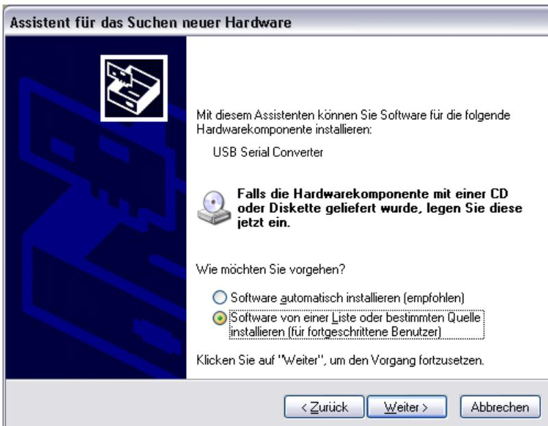
Lassen Sie den Computer die Software **nicht** automatisch installieren, sondern geben Sie an, die "Software von einer Liste oder bestimmten Quelle installieren (für fortgeschrittene Benutzer)".
