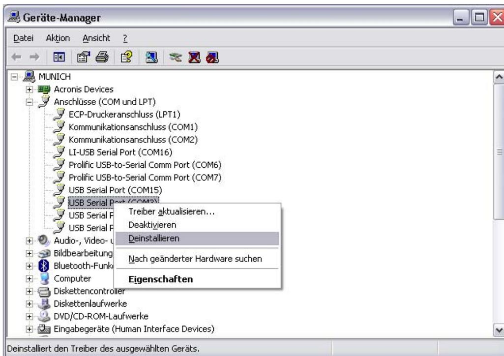
Wählen Sie bitte den Eintrag "Deinstallieren". Der Computer löscht dann alle Treiber aus seinem System.
