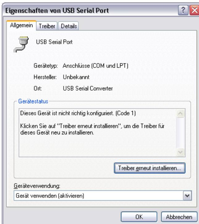
Hier betätigen Sie die Schaltfläche "Treiber erneut installieren", um den Installationsvorgang erneut aufzurufen.
