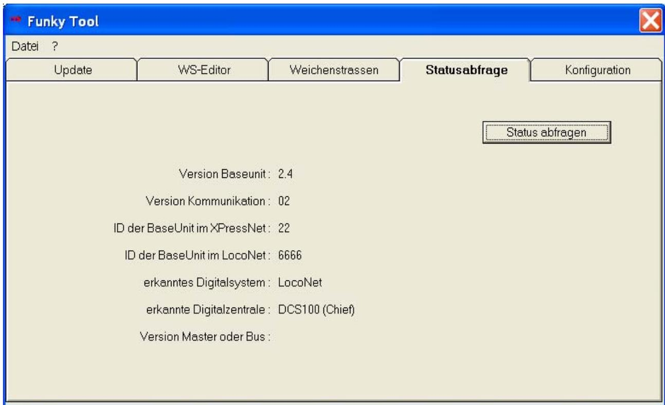
Diese Funktion ist gut für Diagnosezwecke (insbesondere dafür, ob die Kommunikation zwischen Computer und Basisstation funktioniert).
